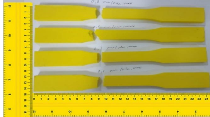
Gambar 5: Hasil pengujian awal untuk pemilihan kecepatan tarik pada mesin uji tarik.
