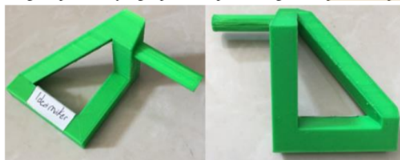
Gambar 8: Hasil cetak produk menggunakan slicer Ideamaker (tanpa pendukung )
