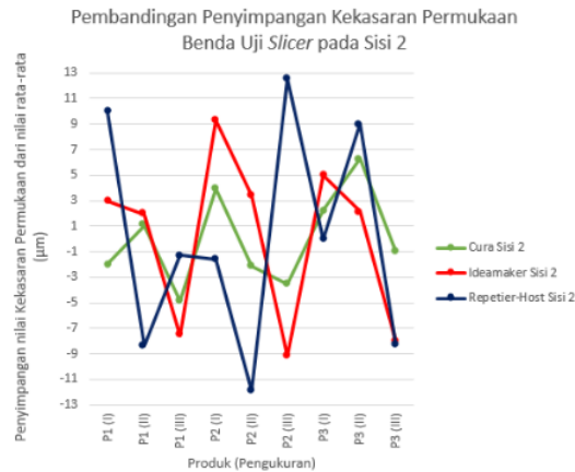
Gambar 13: Pembandingan Kekasaran Permukaan sisi 2 antar slicer
