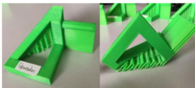
Gambar 5: Hasil cetak produk menggunakan slicer Ideamaker
