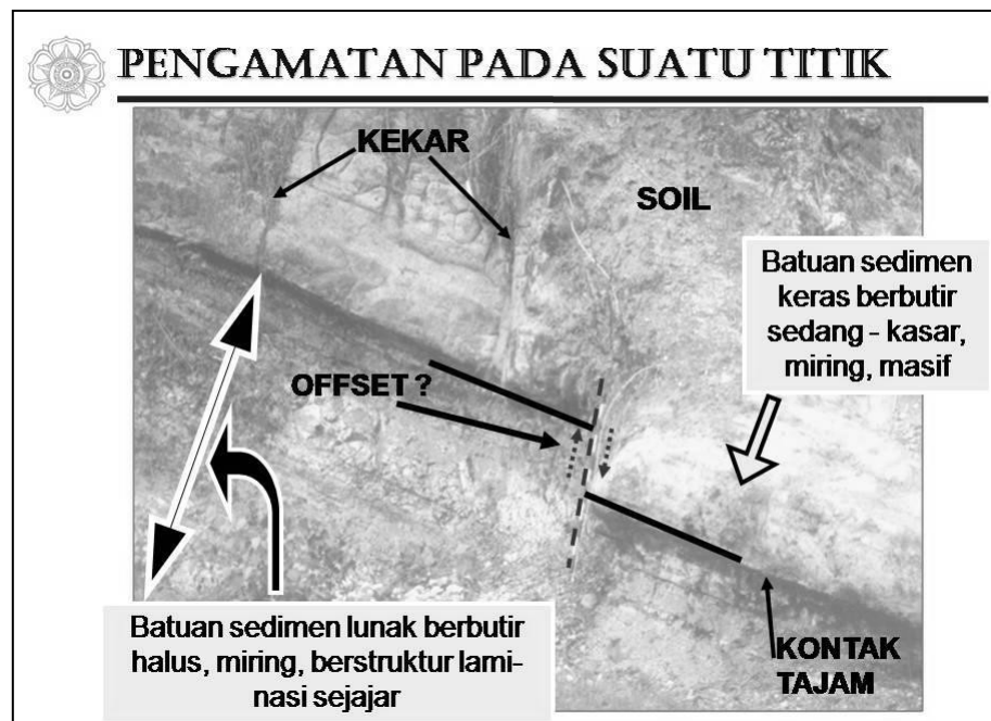
Gambar III.5.4. Sketsa Singkapan pada plastik transparan (Sumber : Rahardjo, 2013)
