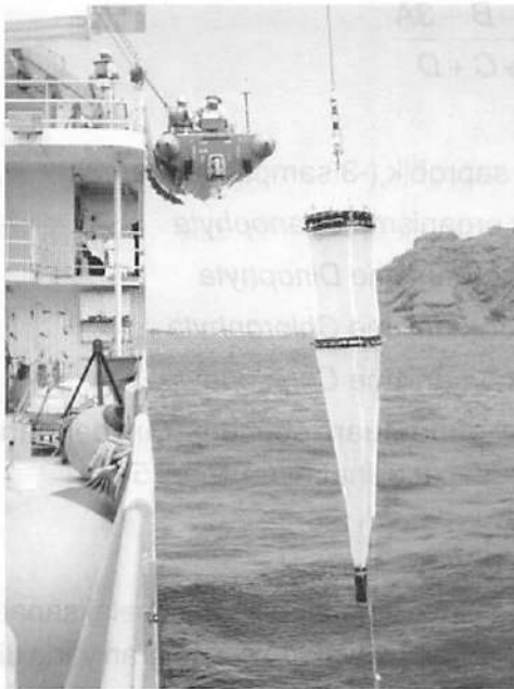
Gambar 5.2 Plankton net ini digunakan untuk menyaring plankton pada perairan laut dalam yang diturunkan dari atas kapal riset
